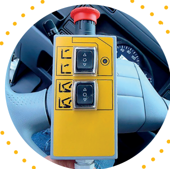
elektrické ovládání mechanismu v kabině elektrisches Bedienpult des Gerätes im Fahrerhaus
