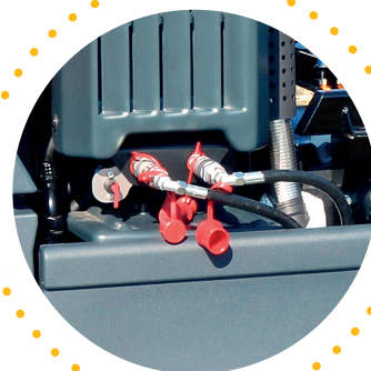
připojení hydrauliky přes rychlospojky Gerät durch Schnellkupplun- gen zum Bordhydraulik anges- chlossen
