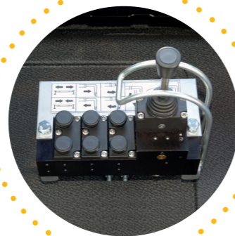
pneumatické ovládání mechanismu v kabině pneumatische Steuerung des Gerätes im Fahrerhaus
