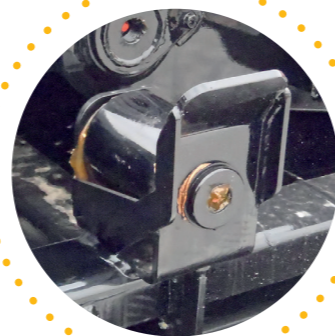
rolna pro hladký posuv kontejneru na mechanismu Stützrolle für reibungslose Containerbewegung
