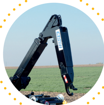
zalamovací hák předního členu Schub-Knick Ausführung
