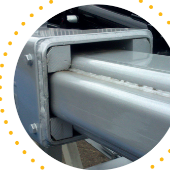
ertalonové bloky pro lepší pohyb předního členu Ertalon-Führung für besseren Hakenauschub
